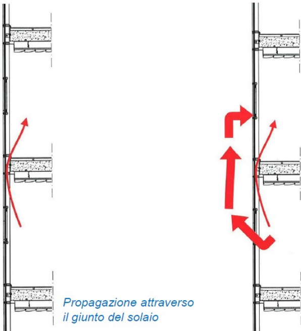
Propagazione attraverso l'esterno per rottura delle vetrazioni
