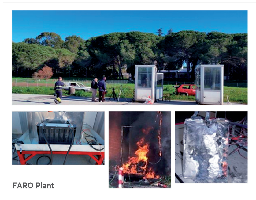
Fig.4 Impianto FARO e prove di abuso su sistemi litio-ione Fonte: Cinzia Di Bari
