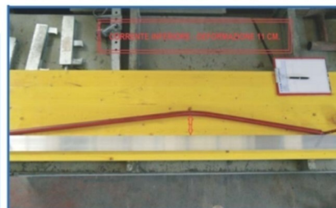
Figura 15 - Deformazione dopo l'impatto del corrente inferiore
