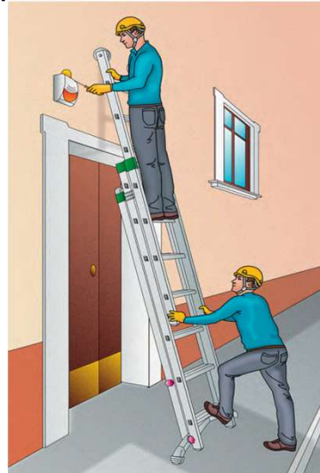
Esempio di scala trasformabile a tre tronchi in configurazione di appoggio
