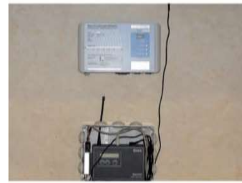
Apparecchio Domodry LS-R15 e Ricevitore FM con modem gsm per il controllo remoto dei parametri microclimatici
