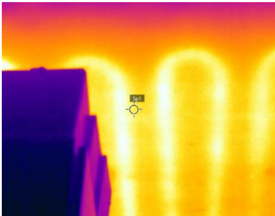
RILIEVO TERMOGRAFICO DEI SOFFITTI RADIANTI E DELLE TEMPERATURE SUPERFICIALI DEI PANNELLI
